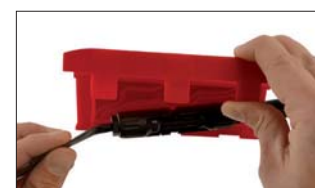
Bei Stromkreiserweiterung oder Klemmen-austausch: Gelbox öffnen, Gelreste von der Klemme entfernen, neu bestücken und Gelbox schließen.
